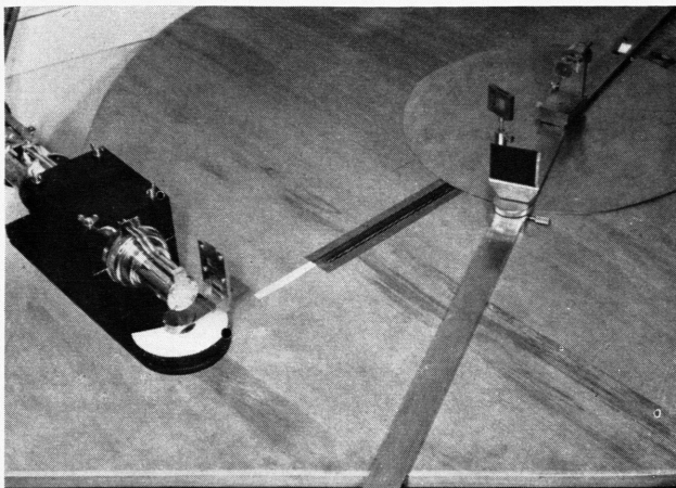
Abb. 8. Experimentelle Anordnung für die Monochromatisierung durch Ausblendung mit einem feinen Strichgitter.
